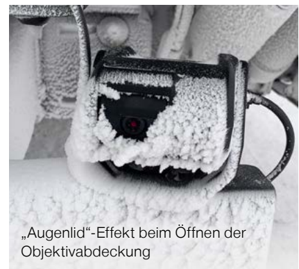
Kamera auch bei Schneefall durch Shuttergehäuse einsatzbereit
