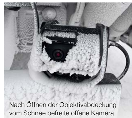
„Augenlid“-Effekt beim Öffnen der Objektivabdeckung
